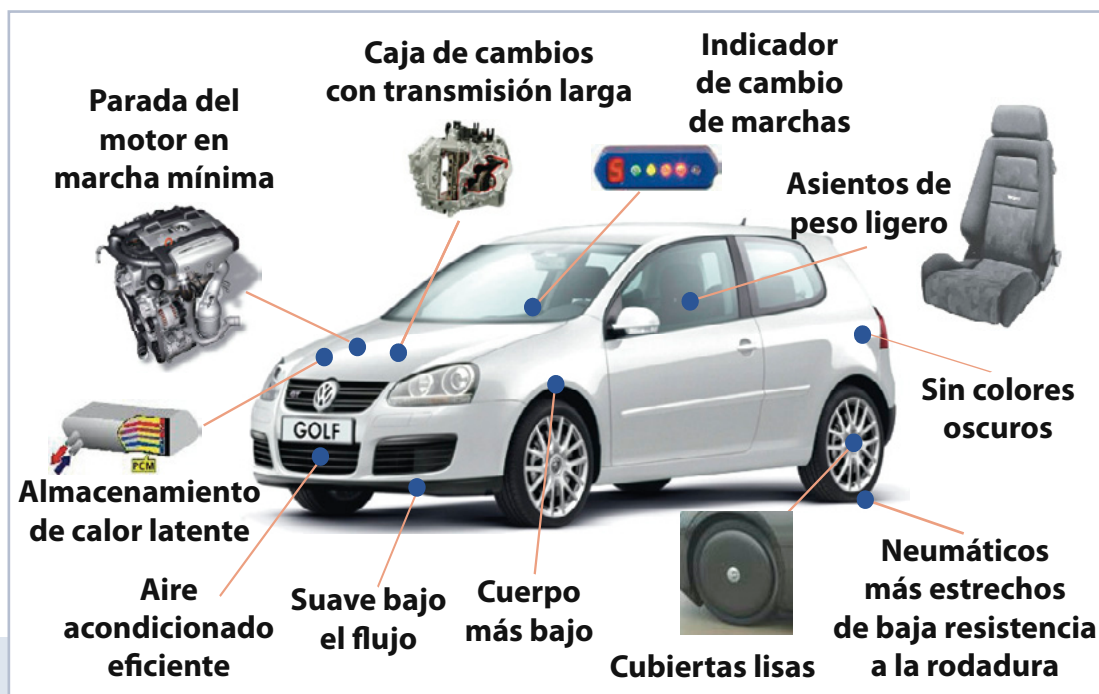
Figura 14: Opciones técnicas para mejorar la eficiencia energética de los LDV. Fuente: Axel Friedrich vía GIZ
